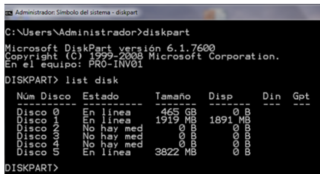
Fig 3 : Procedimiento formateo memoria SD
