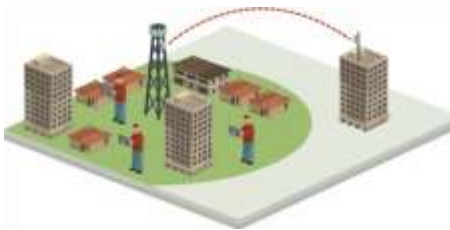
Figura 8. Tecnología Wimax usando el Radio RADWIN 2000. 5
