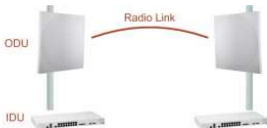
Figura 9. Ejemplo de la arquitectura del enlace – Componentes del sistema.
