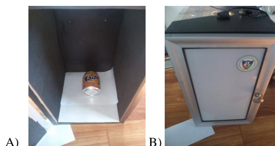
Fig.10: Imagen de la cabina diseñada para la adquisición de imágenes. A) Cabina abierta. B) Cabina cerrada.
