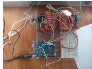
Fig.8: Imagen de la conexión del Arduino y los drivers de control de potencia
